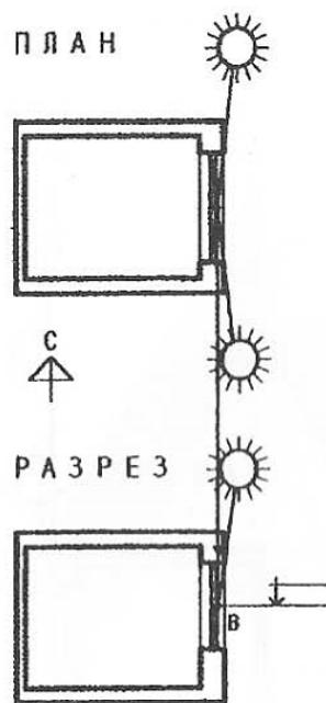
Рис. 1. Схема определения расчетной точки для окна.
