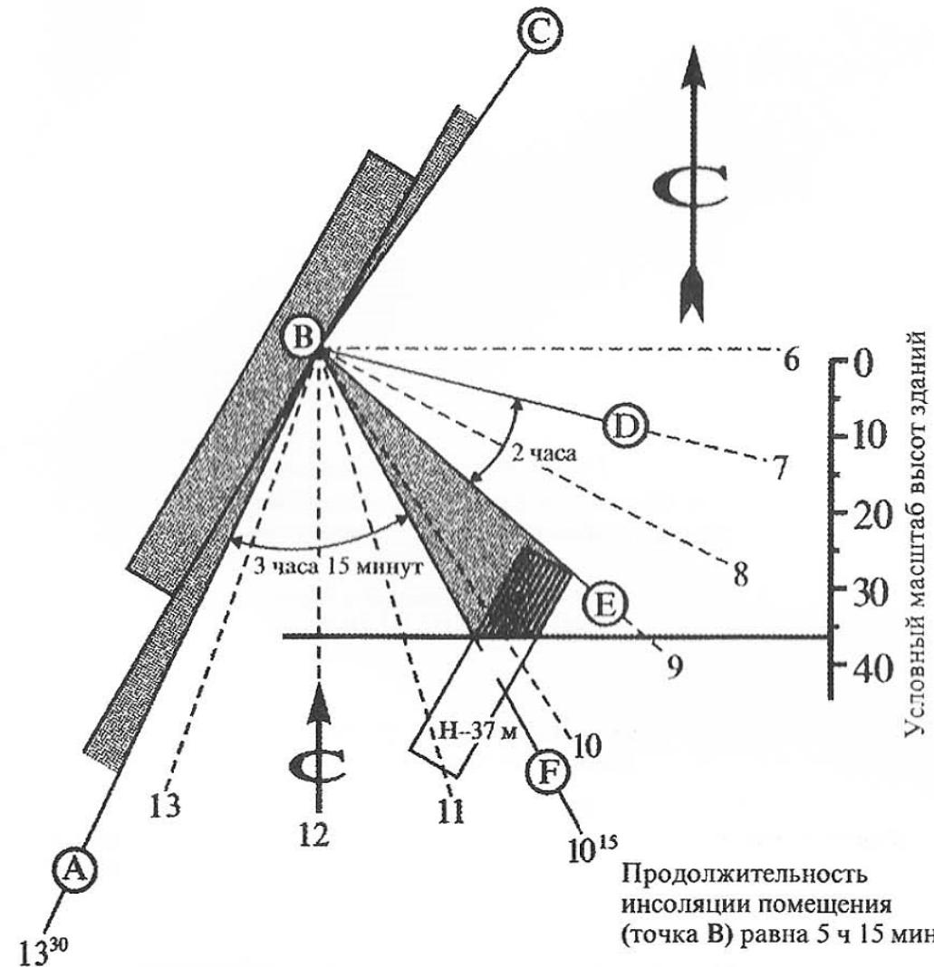
Рис. 5. Схема определения инсоляции.
